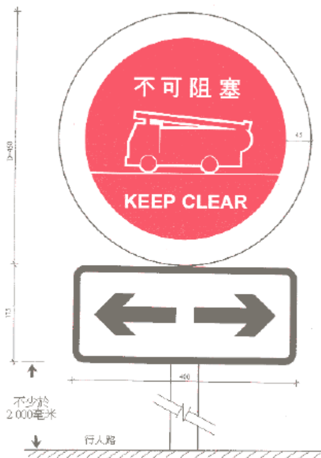
緊急車輛通道 沿着車路形式的緊急車輛通道的指示標誌
